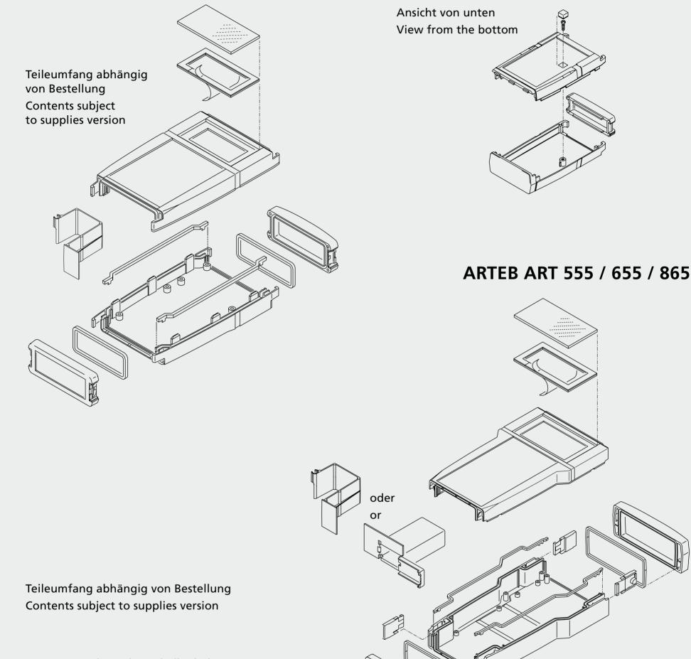
Demontage der Gehäusehalbschalten Dismantling of enclosure parts
